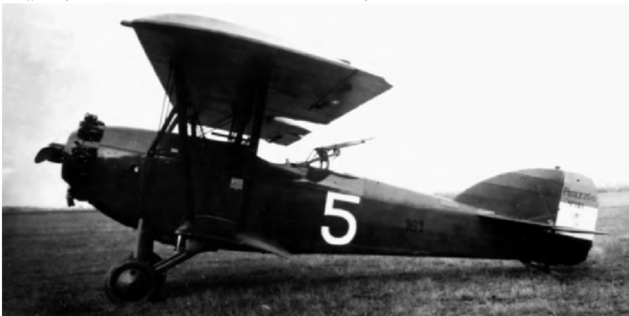
Модификовани „Икарусов“ Потез 25 А2 №161 бели 5 чека такмичење, Београд, 28. август 1930. године. Авион је био опремљен компресорским мотором Јупитер и дуго-долетним резервоарима смештеним у трбушном делу повећаног предњег дела трупа (МВ)
