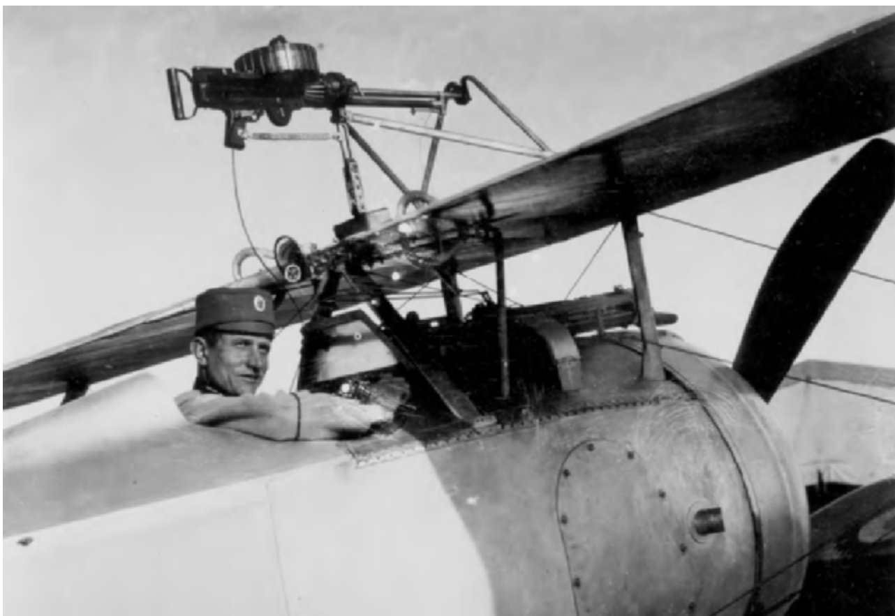
Пор Миодраг Томић у кабини ловца Њепор 23 Ц1 наоружаног са два митраљеза: Викерс тип I синхронизованим да гађа кроз поље елисе, и Луис тип I на горњем крилу. Од првих летова са Барбалушија марта 1913. до тренутка кад је постигао своју прву ваздушну победу, Миодраг Томић је имао преко 400 сати борбеног налета по чему је уз Симишу Стефановића био далеко најактивнији српски пилот (МВ)
