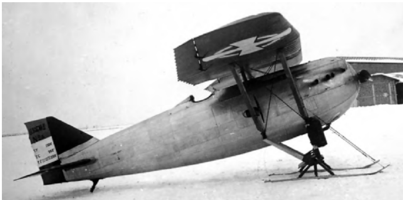
Девотин Д.1 Ц1 (Девотин-Хиспано 300 КС) №8, 1. ваздухопловни пук, Нови Сад, 1927/28. године. Тај тип је био први модерни и главни ловачки тип југословенског Ваздухопловства 1926-1931; у служби до 1937. године. Купљено је укупно 44 авиона. Стајни трап са скијама на овом авиону (МВ)
